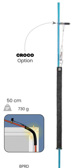
Fourreau flexible en acier spiralé servant à protéger les cordes des arêtes tranchantes. Par sa souplesse, il s'adapte à tous les angles. Les spires en contact de l'arête se compriment sous l'action de la corde lui assurant une protection totale. Le fourreau en acier est quasi indestructible. Son enveloppe protectrice en caoutchouc renforcé qui existe en pièce détachée, peut être remplacée facilement.
