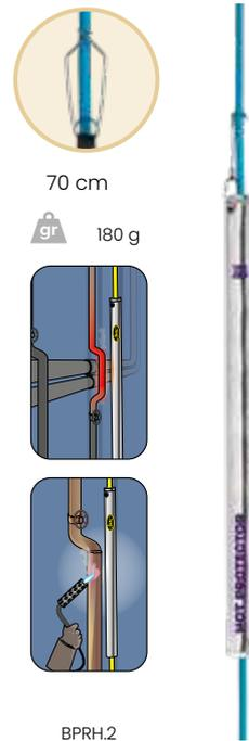
Composé de fibre de verre et d'aluminium, le HOT-PROTECTOR est un protège-cordes breveté résistant à la chaleur, aux projections de soudure ou de disqureuse, à la flamme d'un chalumeau sur une courte durée. Sa mise en place est facilitée par une fermeture magnétique.
