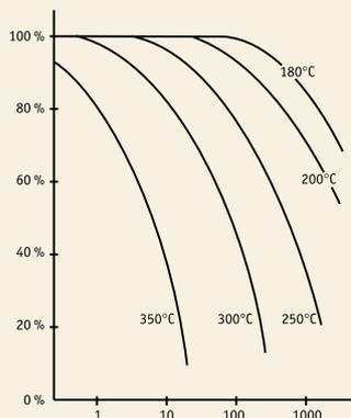
Relation entre le temps d'exposition à haute température et la résistance résiduelle de l'Aramide.
